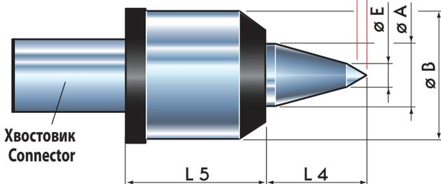
Вращающийся центр VDC-C с подпружиненным удлиненным рабочим конусом
