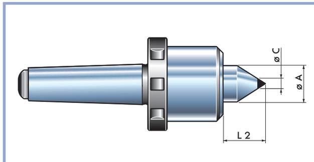
вращающийся центр со сплошным валом и рабочим конусом из твердого металла
